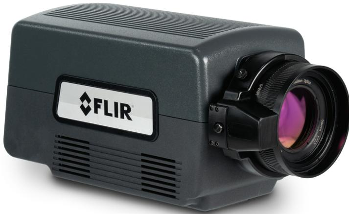
FLIR A8580中波红外高清热像仪可为工业、军事和制造业研发应用提供首屈一指的成像效果。130万像素探测器可生成漂亮、清晰的图像。内置的新型4孔位暖色滤镜轮可使热像仪轻松测量高达3000°C的温度。能提供包括手动及电动两种调焦方式可选的不同焦距的镜头及显微红外镜头，因此用户可实现通过选择合适的镜头及精确调焦从而实现被测物体测量区域像素最大化，消除因被测目标物理大小及物距远近而可能造成的影响，从而确保测温的准确性。通过千兆以太网或CoaXPress简单单线连接，用户在FLIR Research Studio软件中全面控制热像仪、获得图像数据，从而更快地分析和解读数据。
