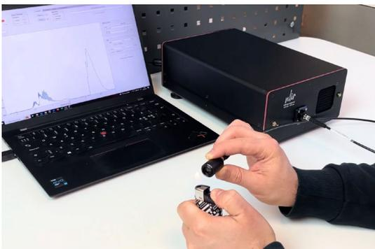
使用 NLIR 的中波光谱仪实时测量燃烧过程的副产物
